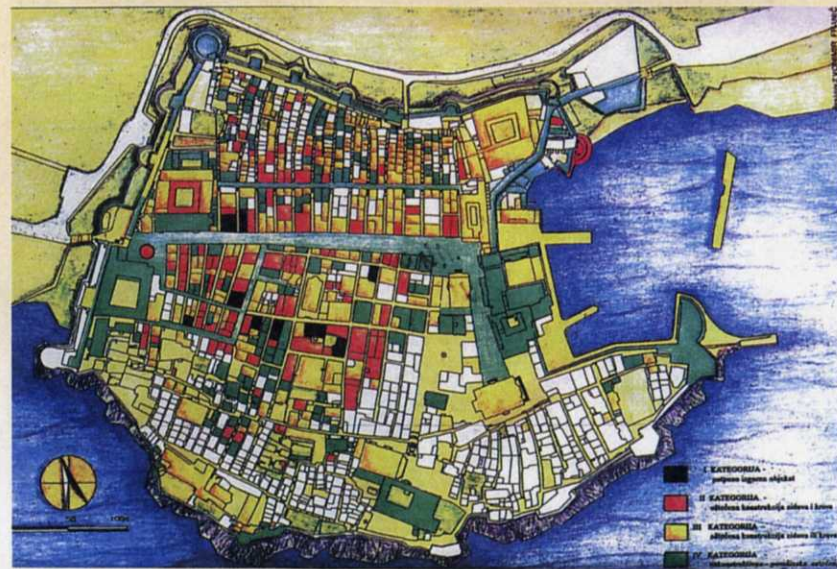
図3 1991年10月から12月の砲撃による建物の被害を示した図。(出典：参考文献2)
