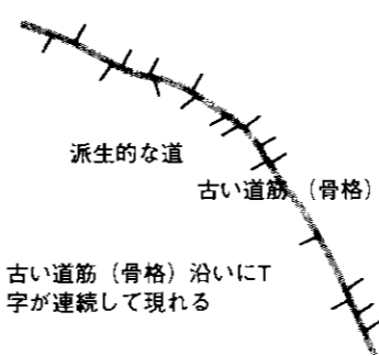
図4 骨格となる古い道筋に見られるT字路の連なり（渋谷区西原）
